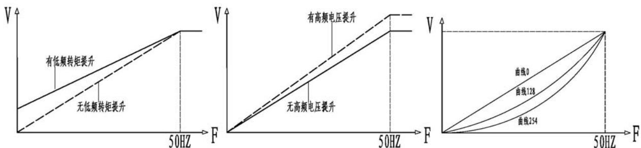
**注意:** 如果“低频转矩提升”值设定过大, 变频启动时可能电流过大引起过流故障跳闸, 需要根据实际负载情况, 来设置转矩提升值。“高频电压提升”数值如果设置过大, 电机高频运行时可能处于过励状态而发热, 变频器“高频电压提升”一般需要根据调试现场负载情况重新设置, 才可以满足现场应用需求。
