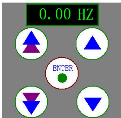
本地频率给定面板的操作方法：点击上图鼠标所在数字位置，系统会弹出数据输入框，可以直接输入给定频率数值，然后点击“ENTER”按钮最终设定；下面的四个按钮用于快速/慢速地增加/减少频率给定。增加或者减少给定值完成后，需要按“ENTER”按钮最终设定。
