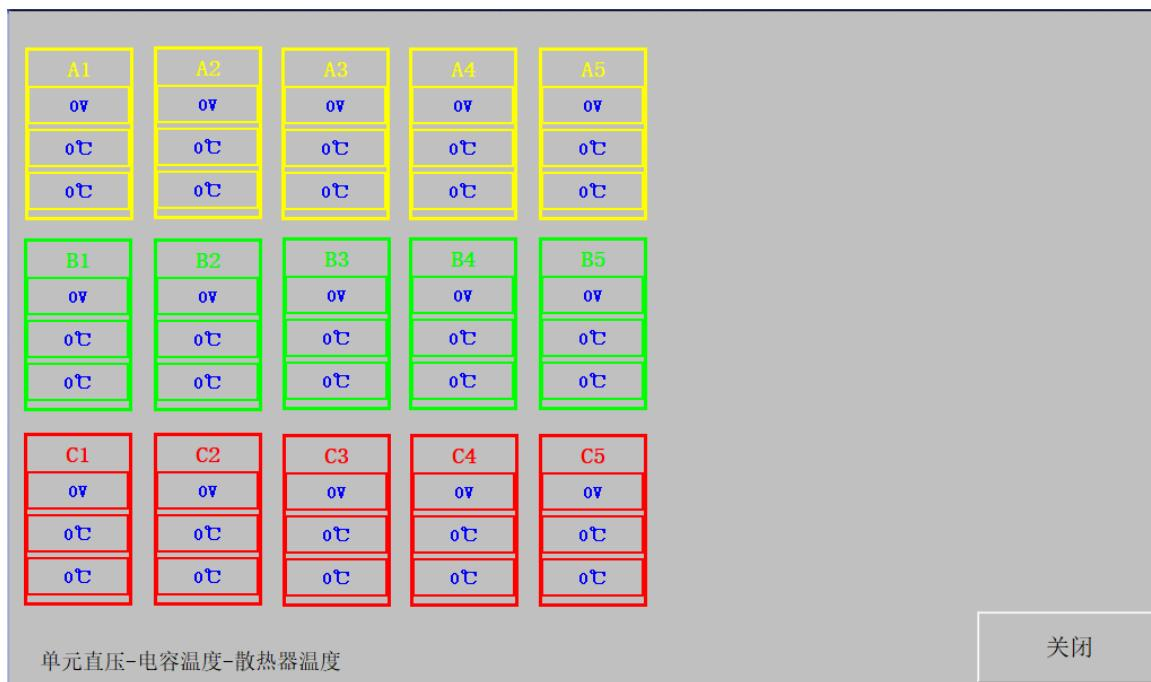
变频器功率单元在高压上电之后，触摸屏单元数据页面能实时显示所有单元的母线电压、电容温度、散热器温度信息。
