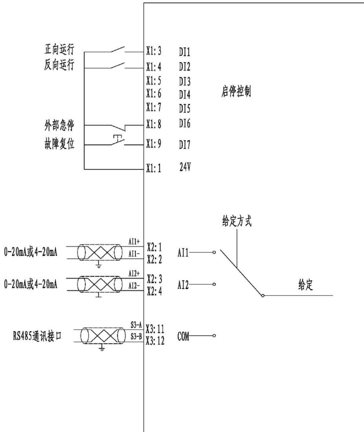
应用说明：“控制与给定”参数中“控制宏设置”参数项数值设定为1时，表示选择工厂宏应用方式有效。此时DI1控制变频器正向运行，DI2控制变频器反向运行。DI1/DI2信号为常保持信号。控制信号逻辑如下图表格所示
