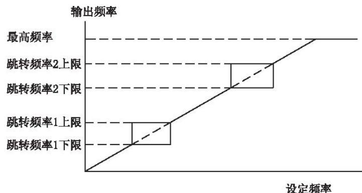
说明：当变频器启动运行时，运行频率从零开始加速到给定频率，所以在加速过程中，变频器运行频率可能出现在“下限频率”以下和“跳转频率”区间。
